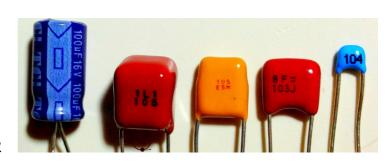
Quando il condensatore è collegato ai terminali di una batteria, gli elettroni si muovono in modo che le piastre diventino cariche.
