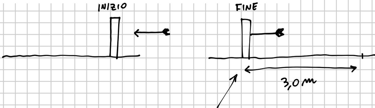
Vettorialmente, l'accelerazione dovuta a  $F_{ATR}$  ha verso opposto a quello della velocità, perché  $F_{ATR}$  è una forza frenante
