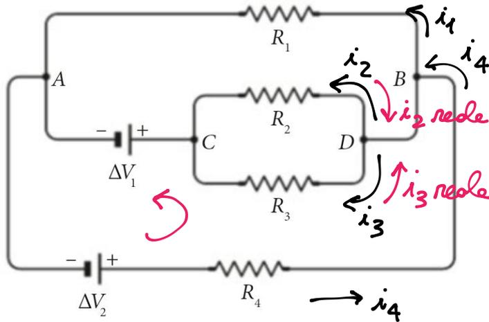
$$\begin{cases} i_4 = i_1 + i_2 + i_3 \\ \Delta V_2 - R_4 i_4 - R_1 i_1 = 0 \\ \Delta V_1 + R_3 i_3 - R_1 i_1 = 0 \\ R_3 i_3 - R_2 i_2 = 0 \end{cases}$$
