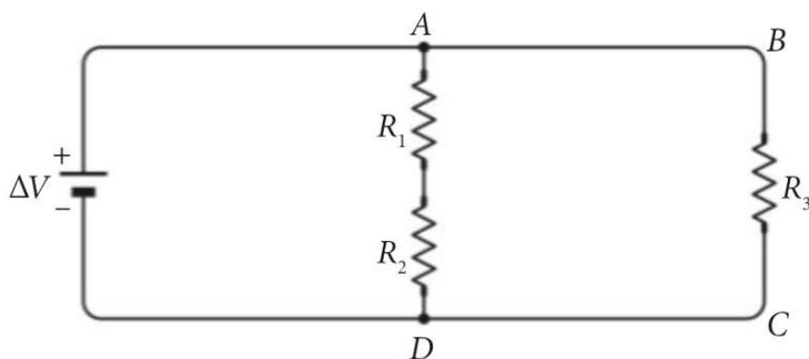
► Verifica che la somma delle potenze dissipate su ogni singolo resistore è uguale alla potenza dissipata dalla resistenza equivalente.
